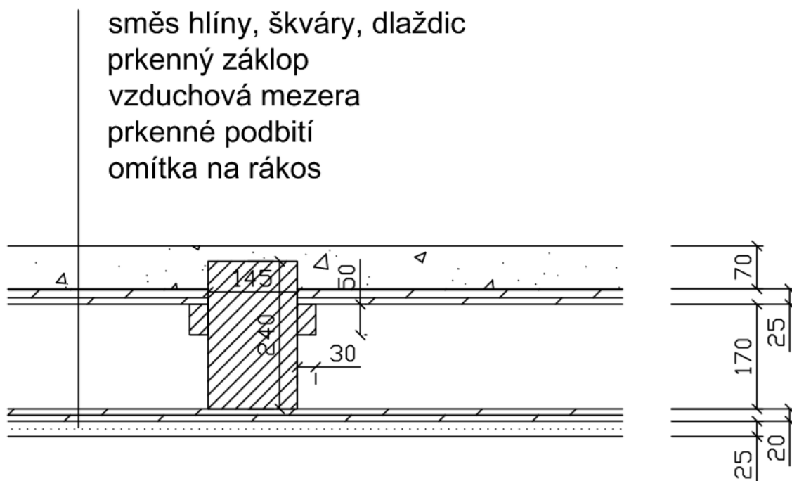
Obr. 6: Skladba stropního pláště včetně popisu vrstev
