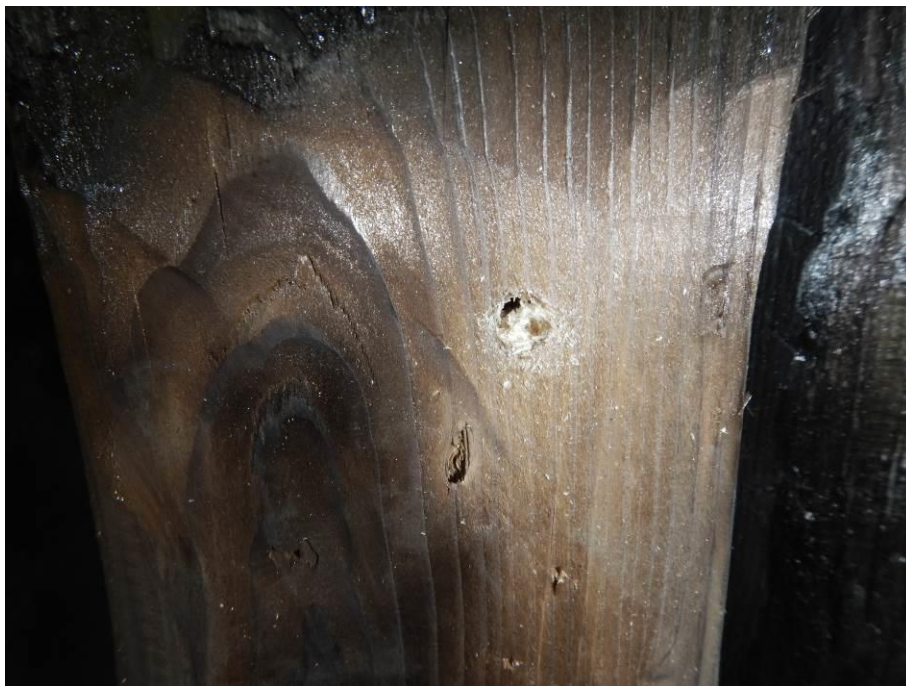
Foto 9: Vývrt do meziokeního sloupku za účelem zjištění vnitřní struktury dřeva
