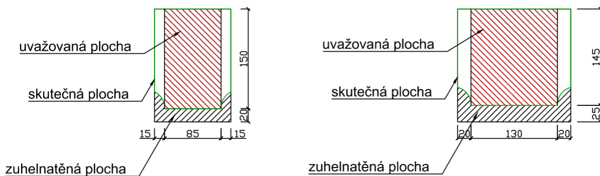
Obr. 7: Příklad tvaru sloupů hrázdné konstrukce, zelený obrys je původní tvar, černě je zobrazena zuhelnatěná plocha, červeně pak uvažová plocha
