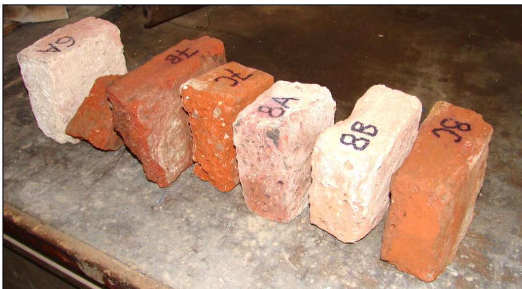
Foto 67: Odebrané vzorky cihel pro destruktivní zkoušky pevnosti v tlaku (vzorky 6 A, 7 A, 7 B, 7 C, 8 A, 8 B, 8 C)
