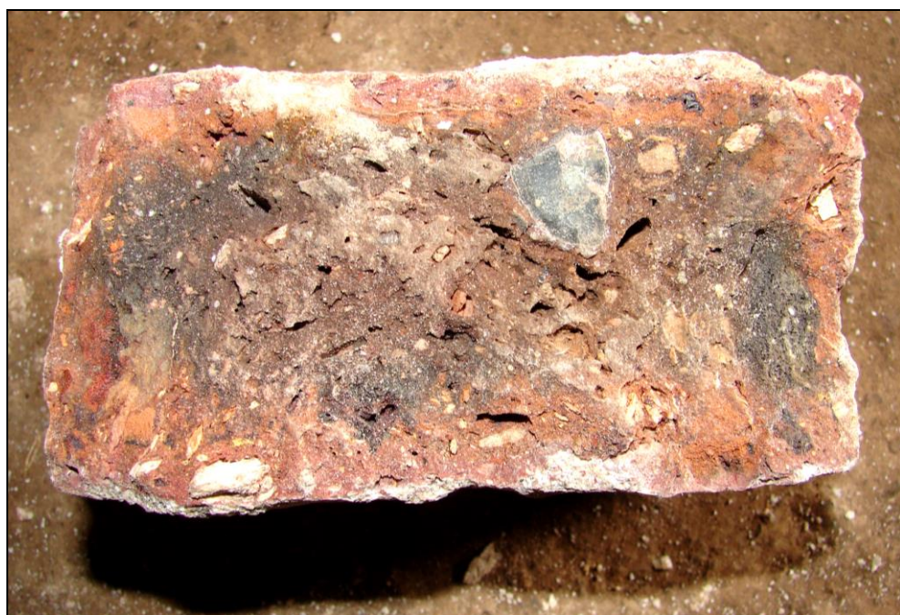
Foto 26: Oblouk 8; charakter cihelného střepu vzorku 8 A
