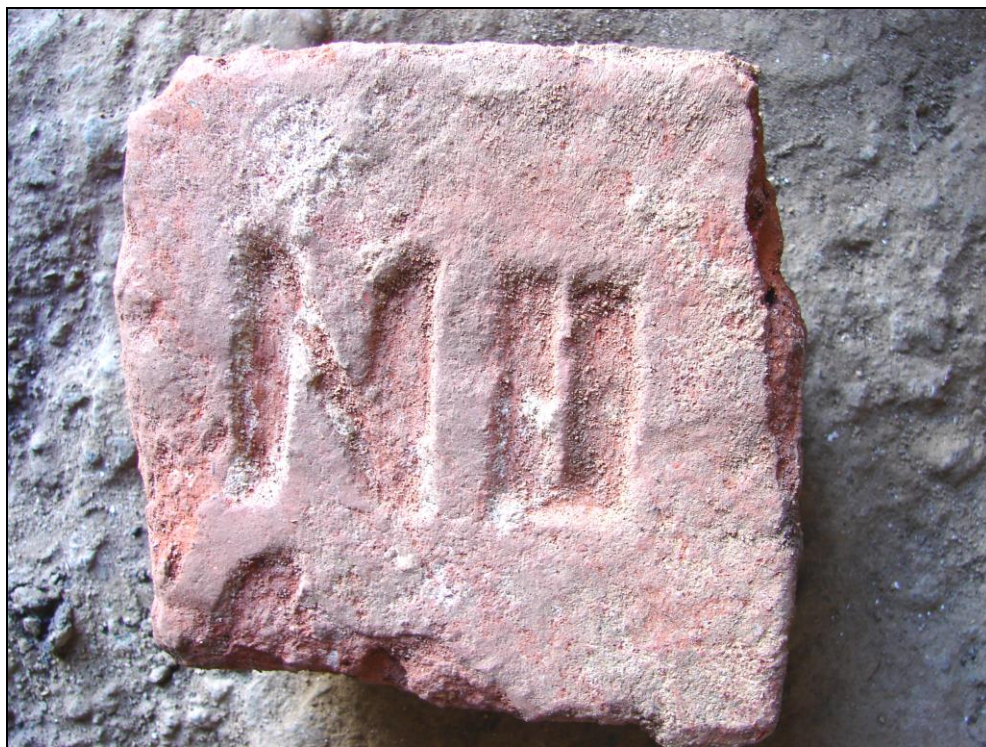
Foto 29: Oblouk 8; značka cihelny na vzorku 8 C
