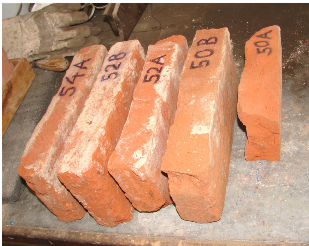
Foto 69: Odebrané vzorky cihel pro destruktivní zkoušky pevnosti v tlaku (vzorky 50 A, 50 B, 52 A, 52 B, 54 A)
