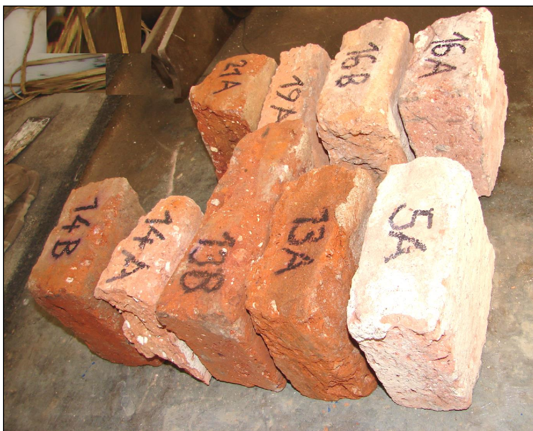
Foto 68: Odebrané vzorky cihel pro destruktivní zkoušky pevnosti v tlaku (vzorky 5 A, 13 A, 13 B, 14 A, 14 B, 16 A, 16 B, 19 A, 21 A)
