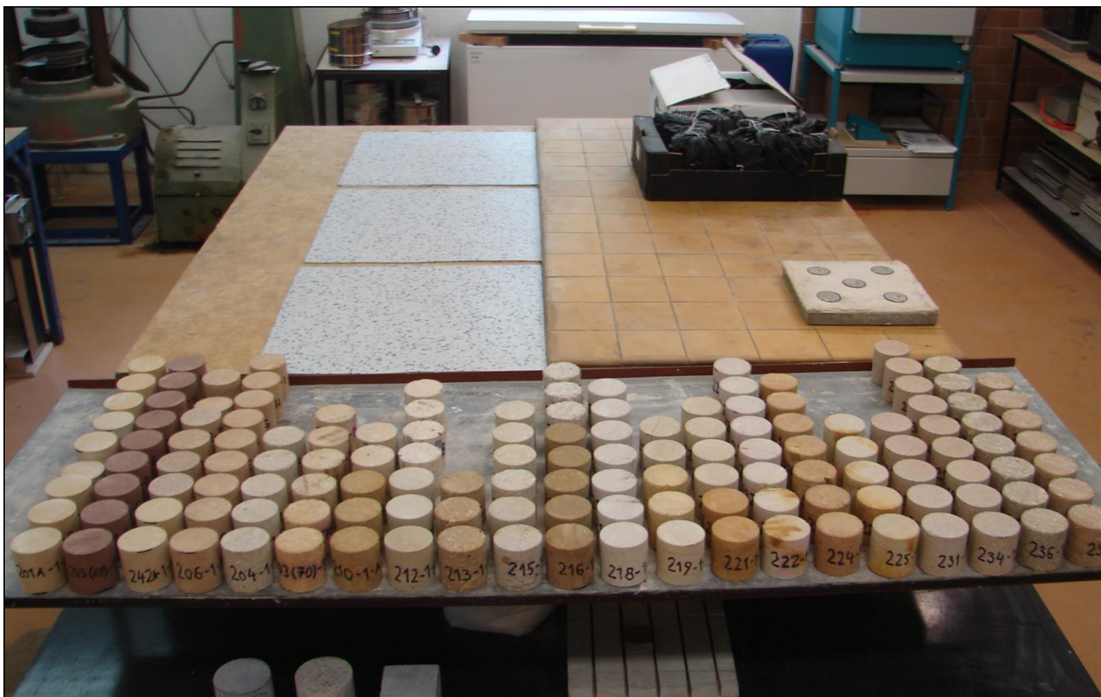
Zkušební vzorky nařezané z jednotlivých jádrových vývrtů (před koncováním)
