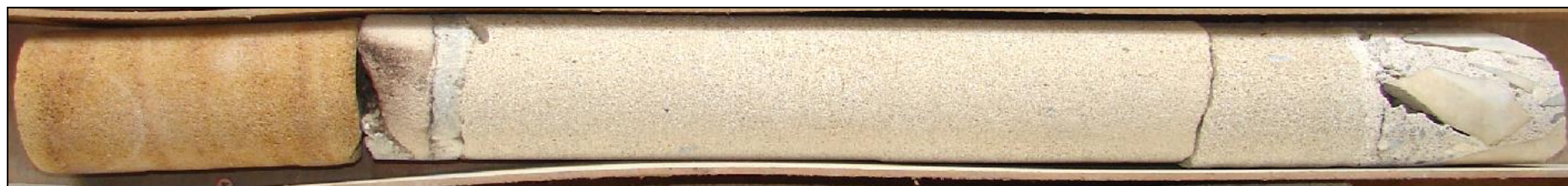
kámen 1 - 170 mm malta - 10 mm kámen 2 - 30 mm malta - 10 mm
