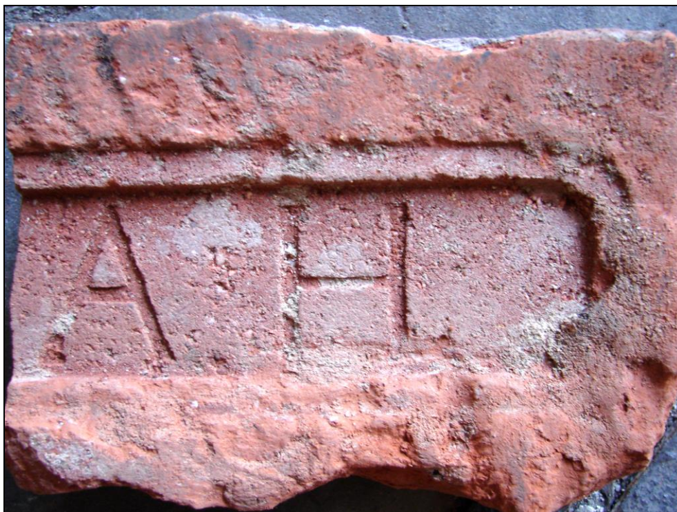
Foto 57: Oblouk 50; značka cihelny na vzorku 50 B, pravděpodobně Hergetova cihelna
