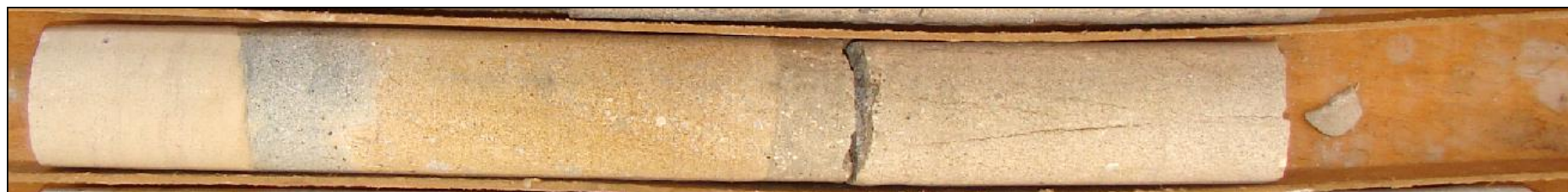
kámen 1 - 110 mm malta - 60 mm kámen 2 - 200 mm malta - 40 mm kámen 3 - 210 mm
