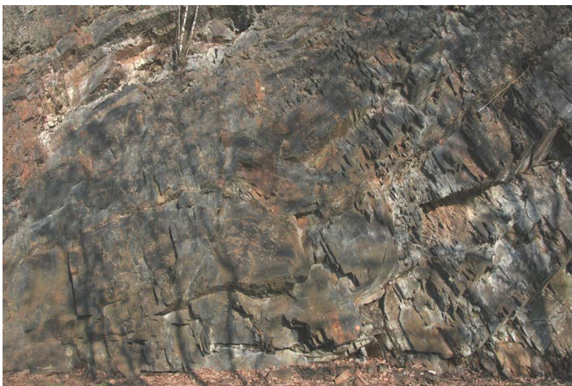
Obr. 8 SO-01 Spojitá deformace, osa vrásky směr SV-JZ
