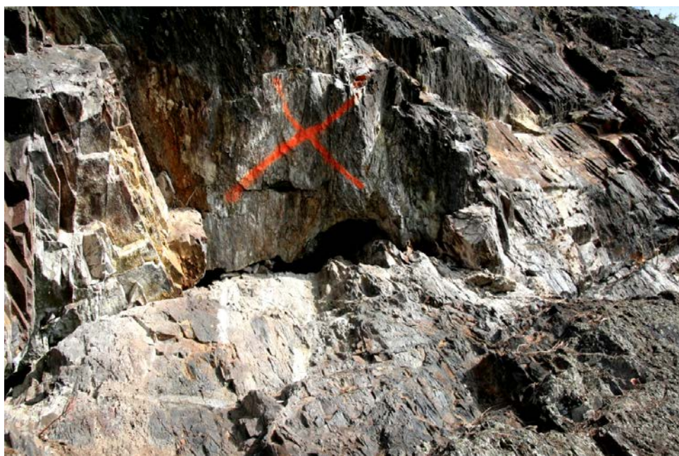
Obr. 3 SO-02 Pohled a na kavernu s patrnými výluhy do hl. až 2,5 m
