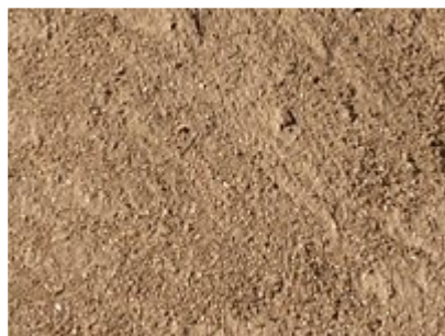
třídněná výkopová zemina 0 – 4 mm
