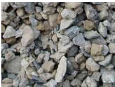
betonový recyklát 32 – 70 mm
