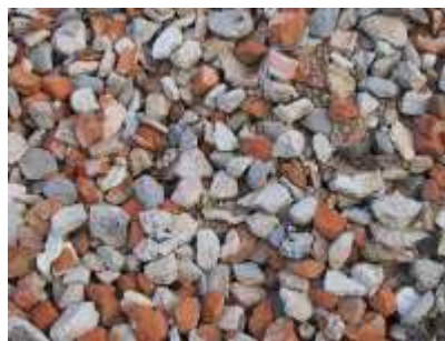
cihelňový recyklát 8 – 32 mm
