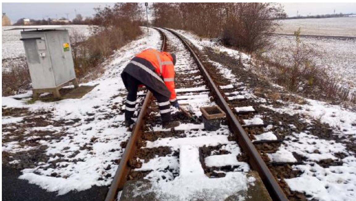
Obr. 5 Výkop a získání vzorku podsítného (sítováním na fr. 0/32) pro posouzení kontaminace štěrkového lože
