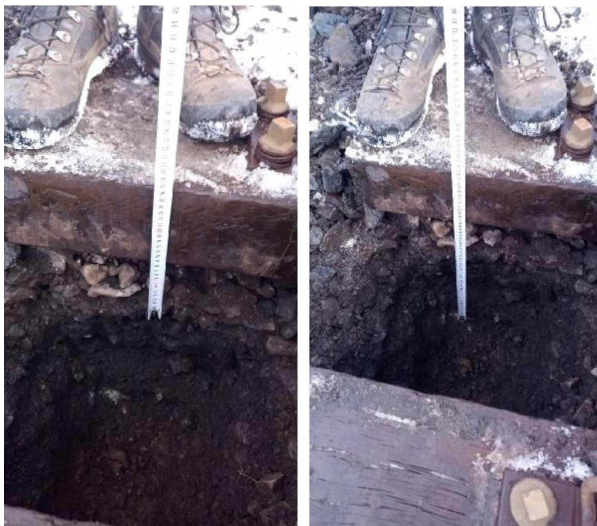
Obr. 2 Aktuální hloubka a stav šterkového lože (vlevo báze čistého ŠL, vpravo znečištěného ŠL)
