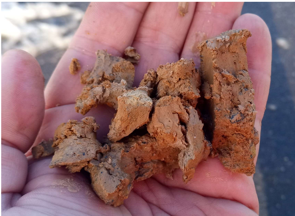
Obr. 5 Detailní pohled na charakter zemin současné i budoucí subpláně (tvořena hnědým písčitým jílem)
