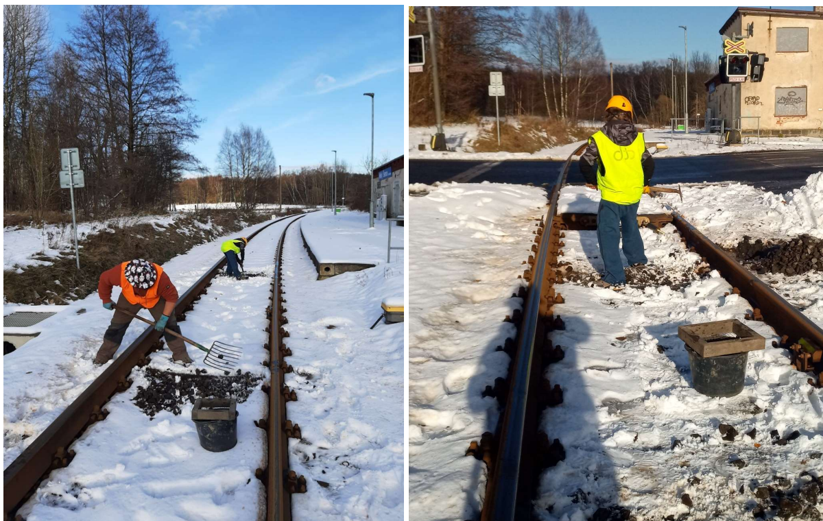
Obr. 6 Místa odběru materiálu šterkového lože a jeho sítování na podsítné fr. 0/32 pro laboratorní posouzení kontaminace
