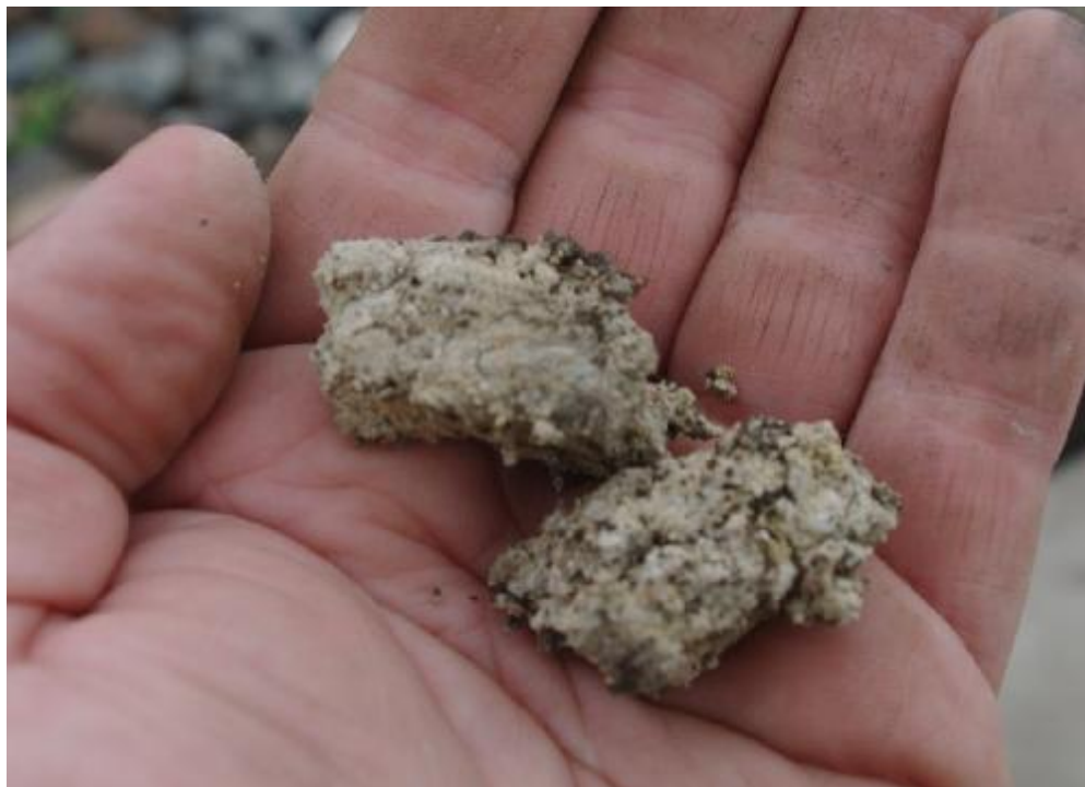
Detail výnosu zarážené sondy (zeminy zemní pláň)
