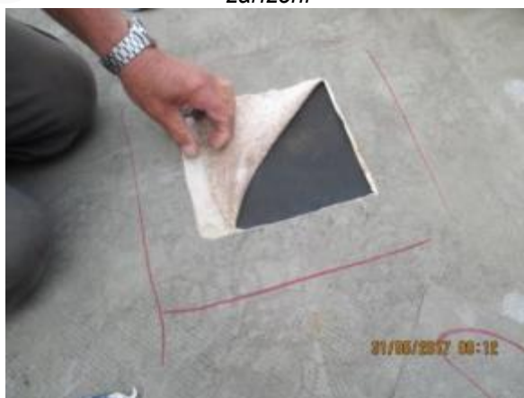
Obr. 83: Provedení sondy do střešního pláště
