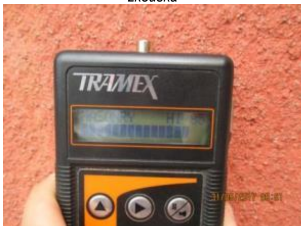
Obr. 209: Měření vlhkosti v omítce
