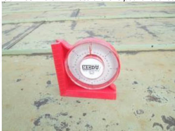
Obr. 110: Sklo střechy se severní orientací 4°
