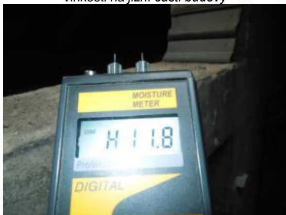
Obr. 134: Měření vlhkosti na jižní části budovy – krokev v místě viditelné netěsnosti krytiny
