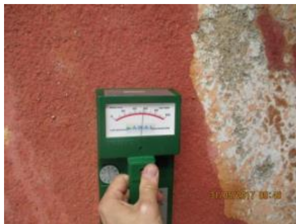
Obr. 208: Měření vlhkosti v omítce – impedanční zkouška
