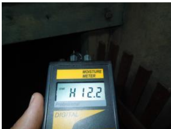
Obr. 130: Měření vlhkosti na jižní části budovy – krokev v místě viditelné netěsnosti krytiny
