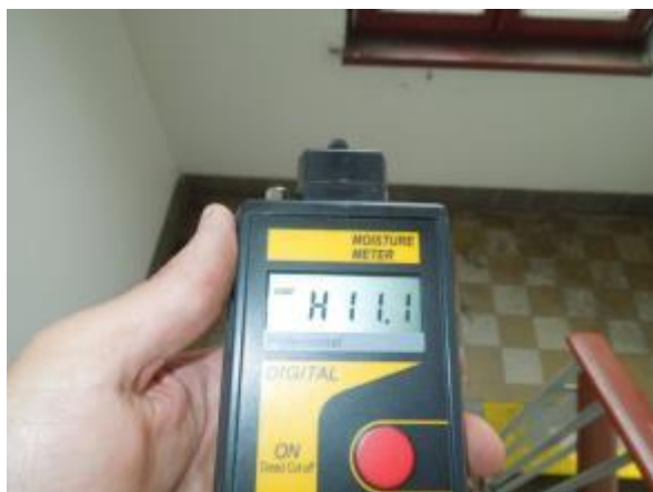
Obr. 131: Měření vlhkosti na jižní části budovy – vodorovný trám v místě viditelné netěsnosti krytiny
