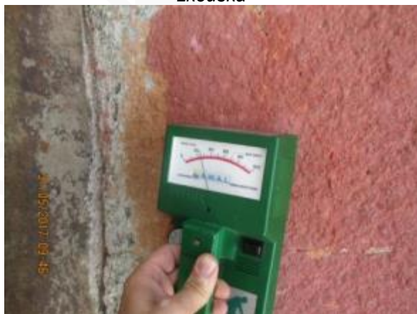
Obr. 205: Měření vlhkosti v omítce – impedanční zkouška
