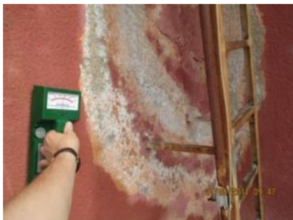
Obr. 207: Měření vlhkosti v omítce – impedanční zkouška
