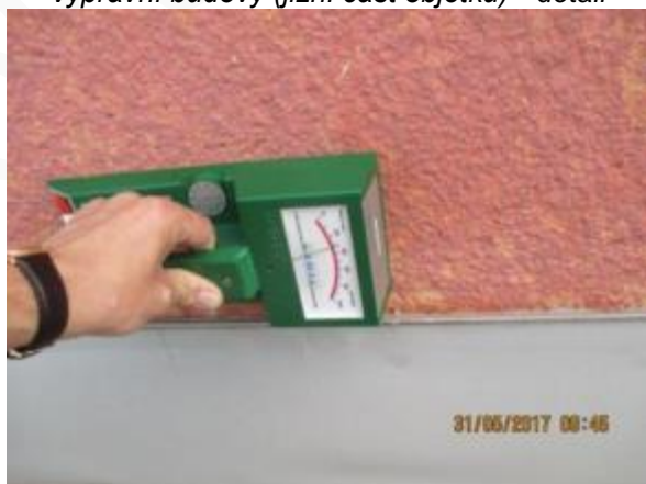
Obr. 204: Měření vlhkosti v omítce – impedanční zkouška
