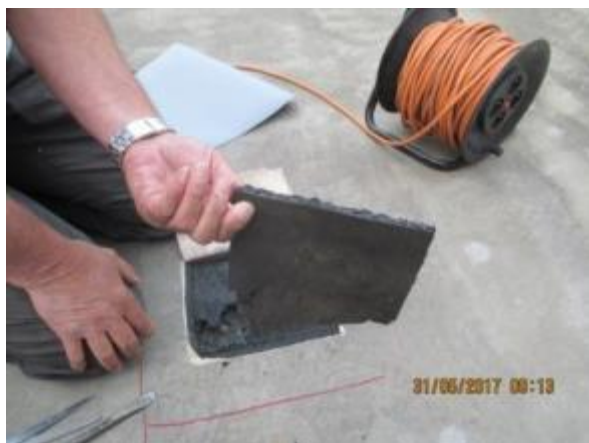
Obr. 84: Provedení sondy do střešního pláště
