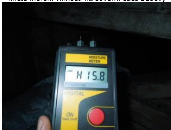
Obr. 145: Měření vlhkosti na jižní části budovy – vodorovný trám v místě viditelné netěsnosti krytiny
