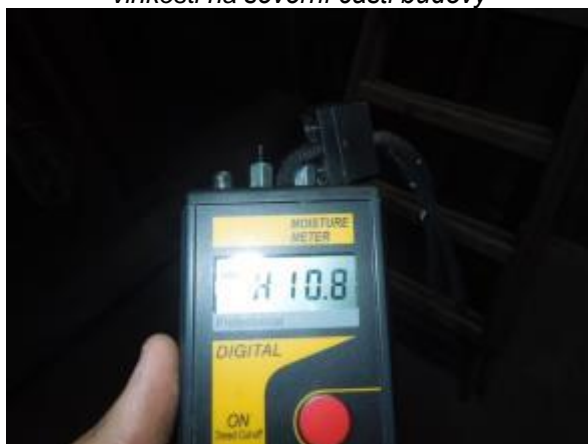
Obr. 135: Měření vlhkosti na jižní části budovy – vodorovný trám v místě viditelné netěsnosti krytiny
