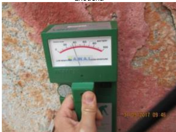
Obr. 206: Měření vlhkosti v omítce – impedanční zkouška
