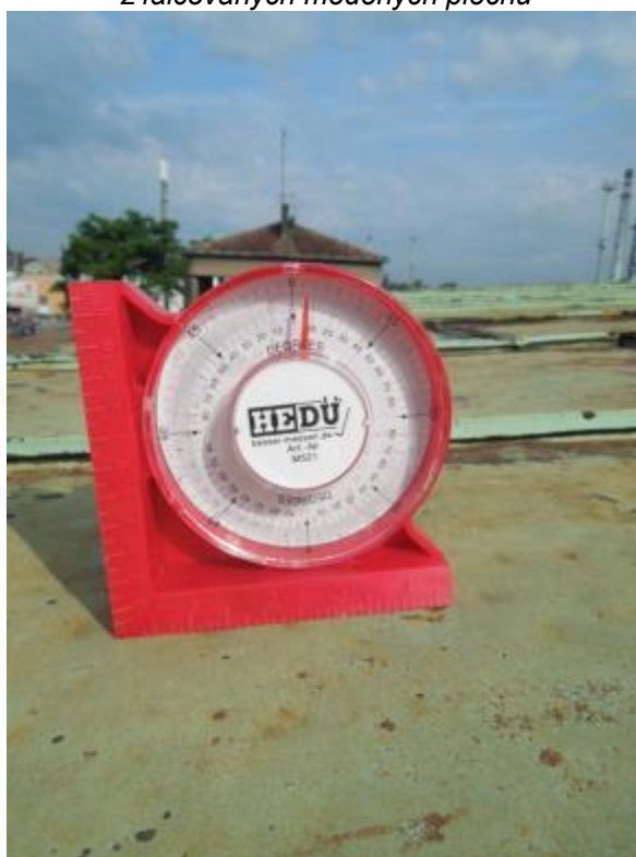
Obr. 109: Sklon střechy s jižní orientací 5°
