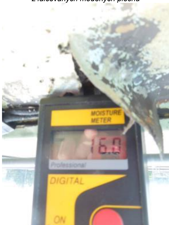
Obr. 108: Měření vlhkosti dřevěné podkonstrukce
