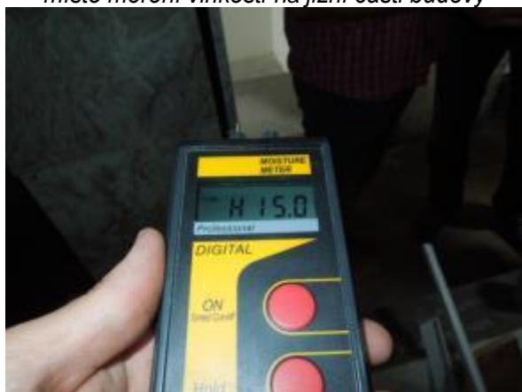
Obr. 144: Měření vlhkosti na jižní části budovy – krokev v místě viditelné netěsnosti krytiny
