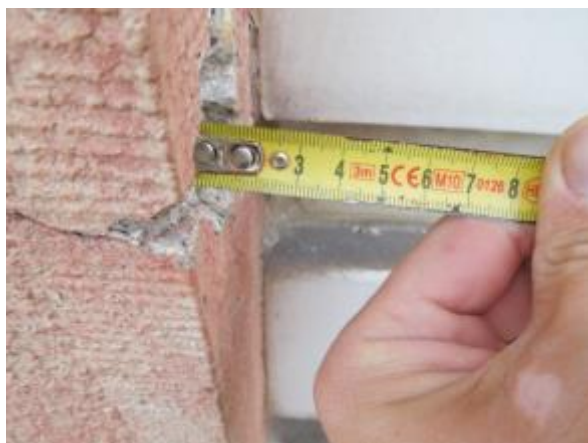
Obr. 234: Sonda do omítky fasády v jižní části (uliční) výpravní budovy
