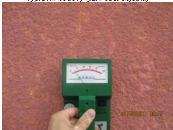
Obr. 203: Měření vlhkosti v omítce – impedanční zkouška
