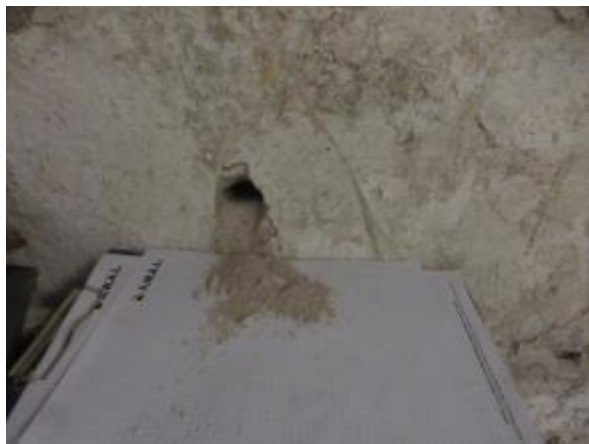
Obr. 288: Odběr vzorku pro laboratorní rozbor
