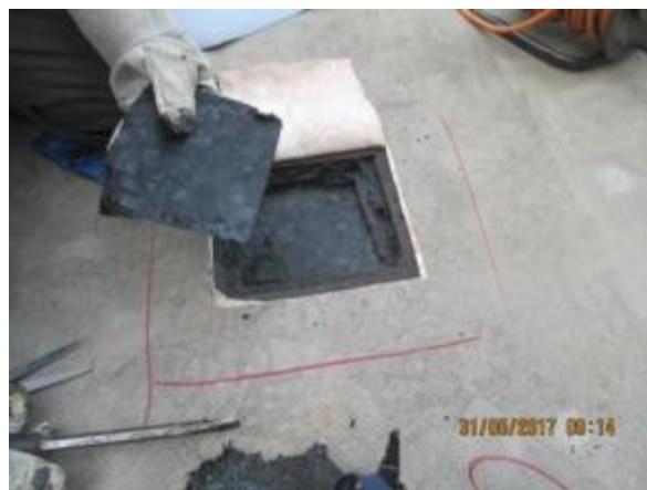
Obr. 85: Provedení sondy do střešního pláště
