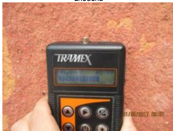
Obr. 210: Měření vlhkosti v omítce
