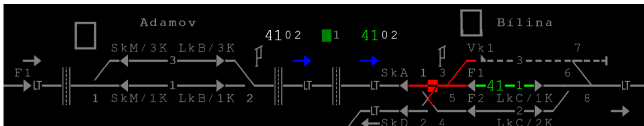
Obrázek 8 – Obsazení KÚ zhlaví přední dopravní D3 Bílina a přestavení výhybky se samostatným přestavíčkem č.3
