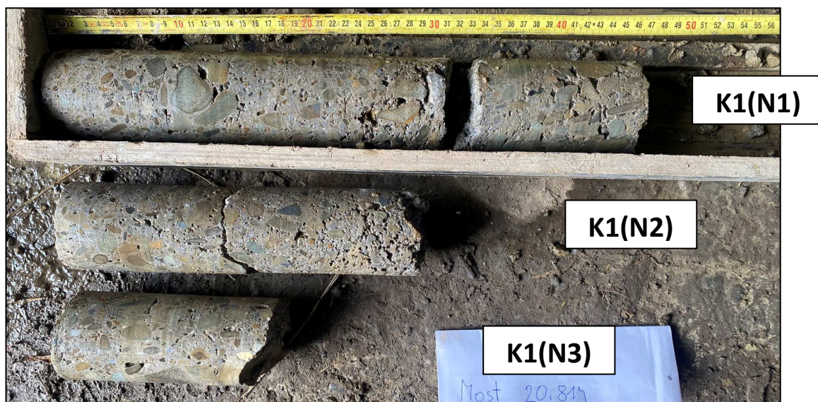
Obr. č. 3 - diagnostické návrtv v klenbě K1 (N1+N2+N3)
