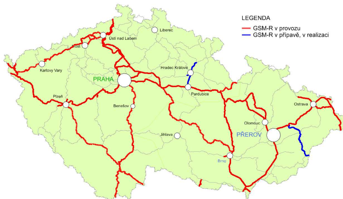
Obr. 1 –Stav rádiového systému GSM-R v síti Správy železnic (v provozu, v realizaci)
