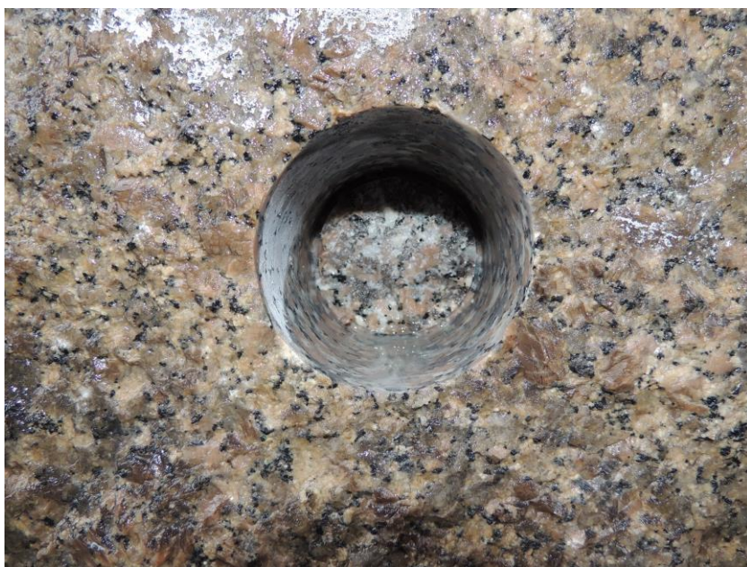
Pohled do otvoru po odběru vzorku
