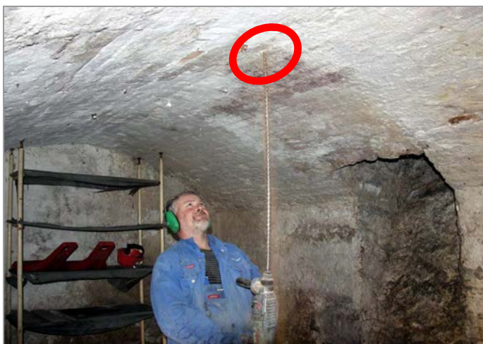
foto 19, 20: Průzkumný vrt V-4 do klenby nad 1.PP pro ověření skladby stropní konstrukce
