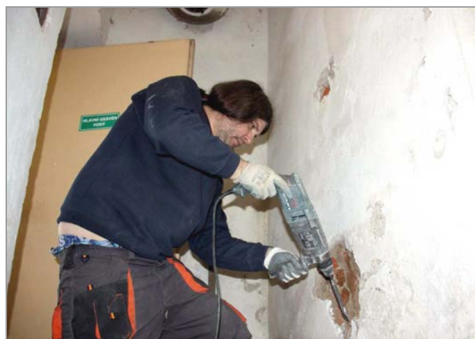
foto 18: Odběr vzorků omítky vlhkostního profilu W-1
