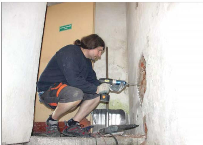
foto 15, 16: Ověřování pevnosti cihelného zdiva metodou místního porušení v sondě Z-1 v 1.NP
