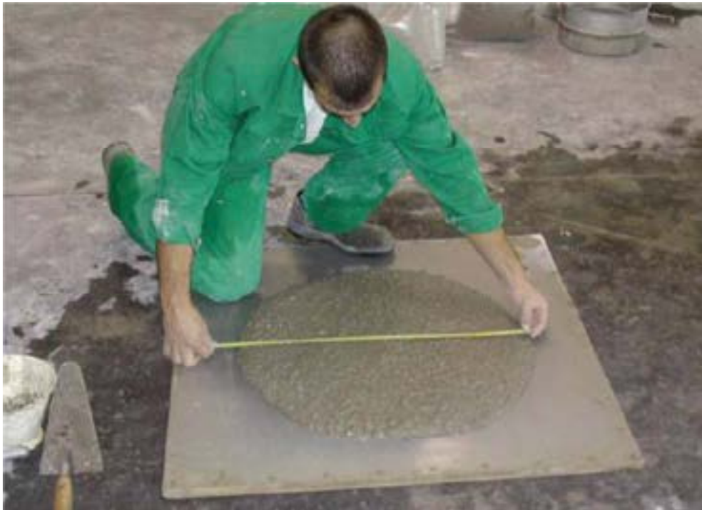
(3) Obr. 3 – Zkouška rozlití SCC - správně navržená směs
