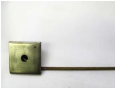
obr. 3b Měřicí vývod z výztuže (C.R.M.) 60 x 60 mm, uzavřený závit, určeno pouze pro účely měření BP
