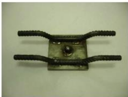
obr. 3a: Měřicí vývod z výztuže (C.R.M.) 100 x 100 mm, uzavřený závit, určeno i pro účel uzemnění
