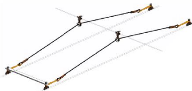
Obr 26. Delta závěs trakčního vedení trolejbusu
