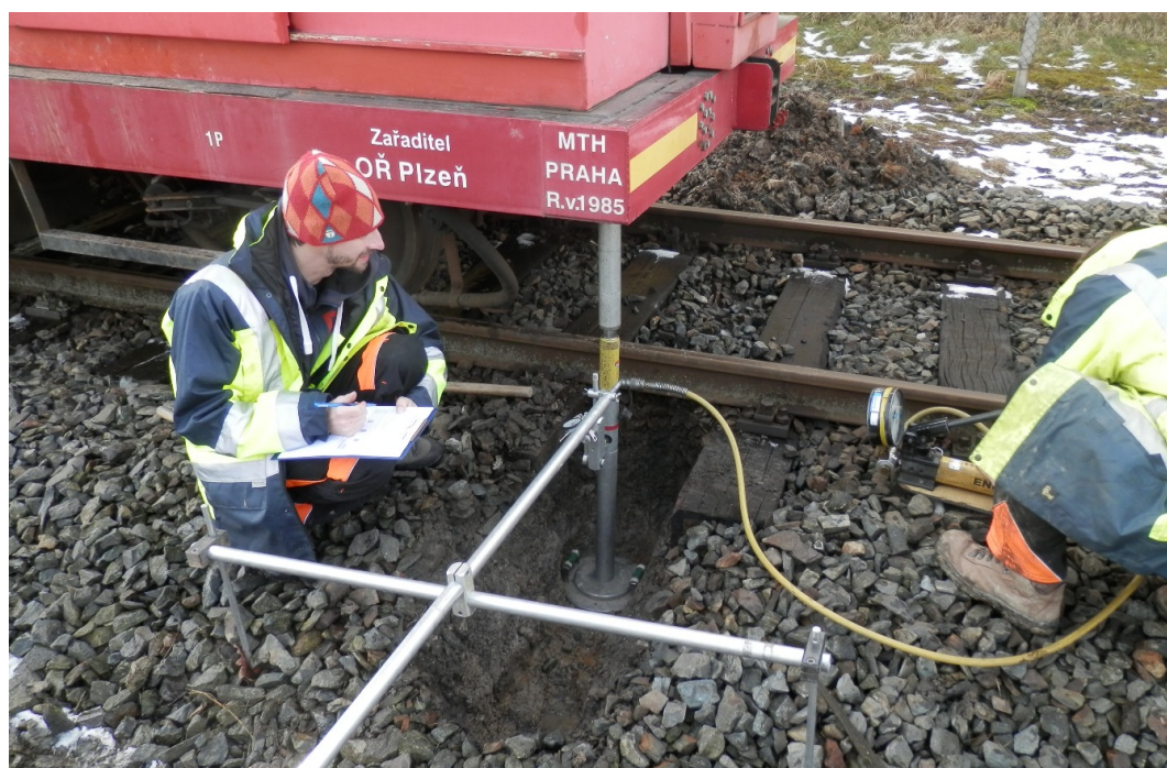
Obr. 2 Statická zatěžovací zkouška v sondě KS-1
