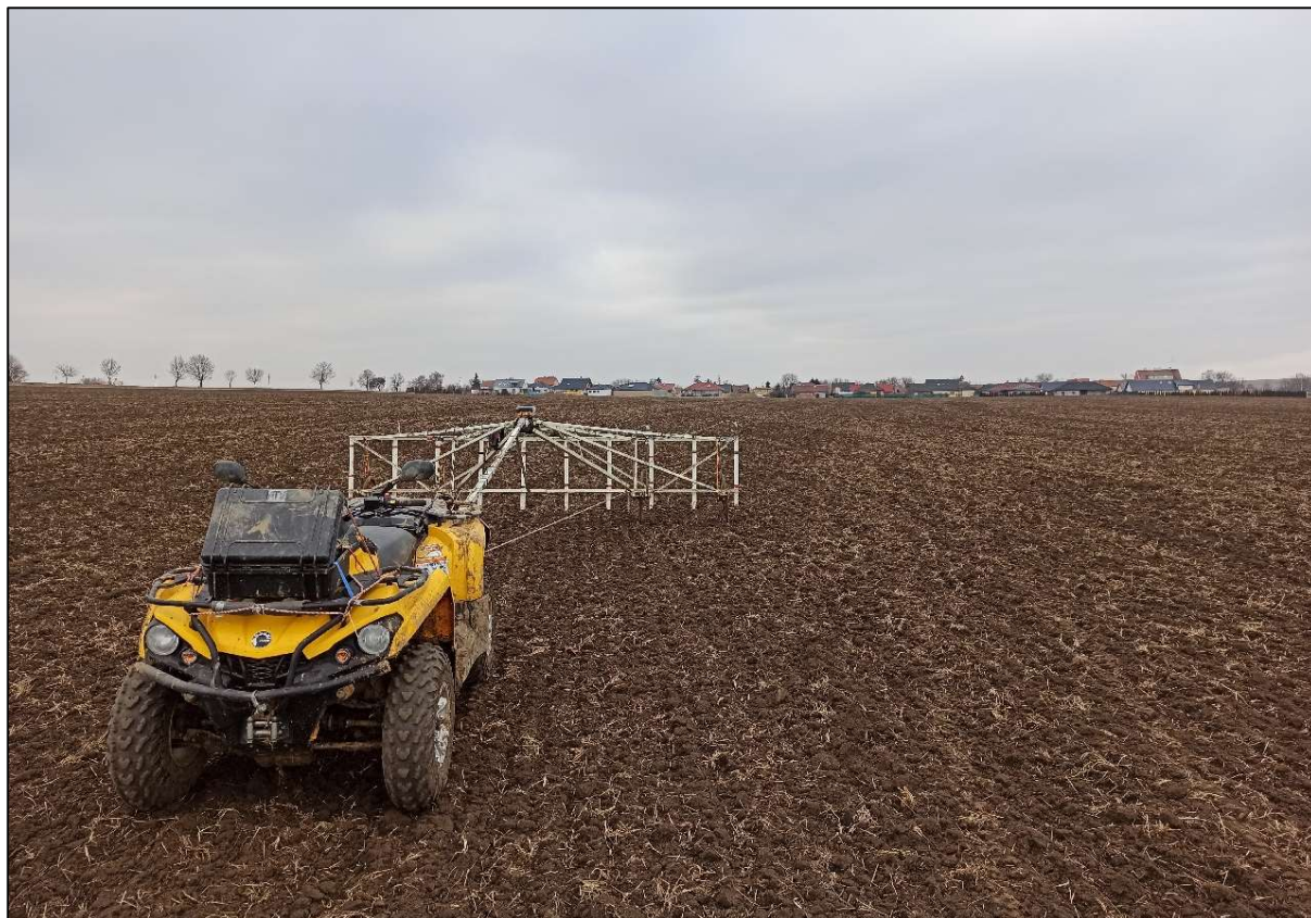
Obr. 7 Fluxgate magnetometr LEA MAX v „ATV“ módě (Eastern Atlas, Německo).
