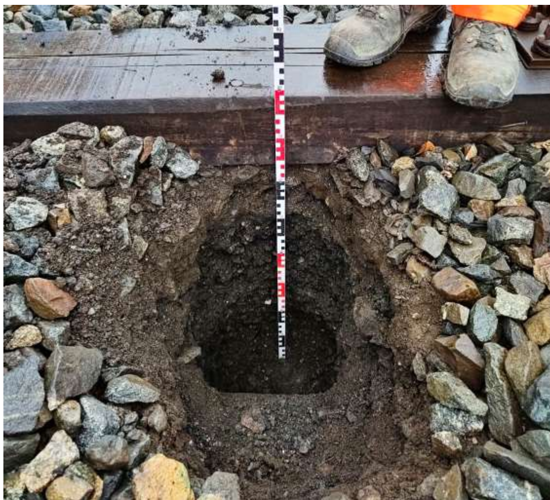
Obrázek 5: Hloubka kopané sondy – 80 cm pod HPP
