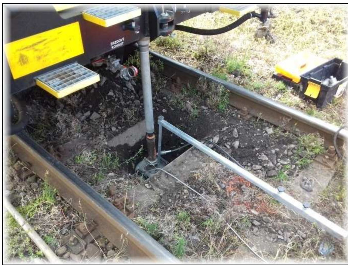
Obr.4– Pohled na ručně kopanou sondu KS2 a místo dynam. penetrace DP2 v ose kolejiště
