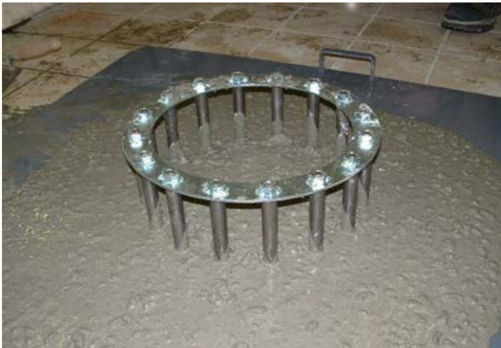
(10) Obr. 10 – Zkouška SCC J-kroužkem – správně navržená směs, bez blokáce a segregace u výztuže (skelet J-kroužku)
