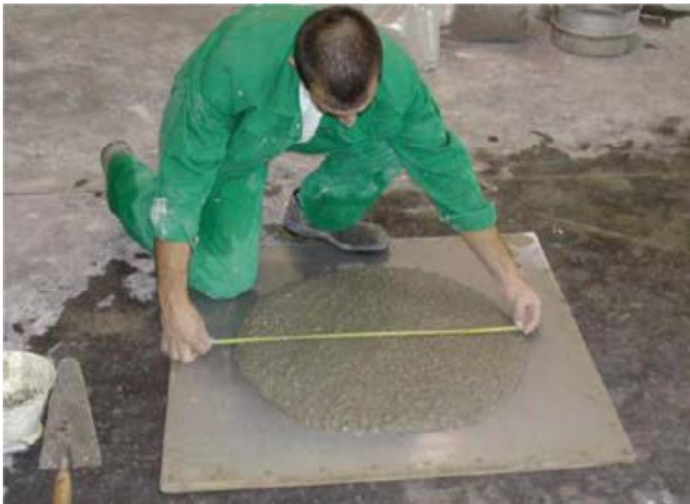
(3) Obr. 3 – Zkouška rozlití SCC - správně navržená směs
