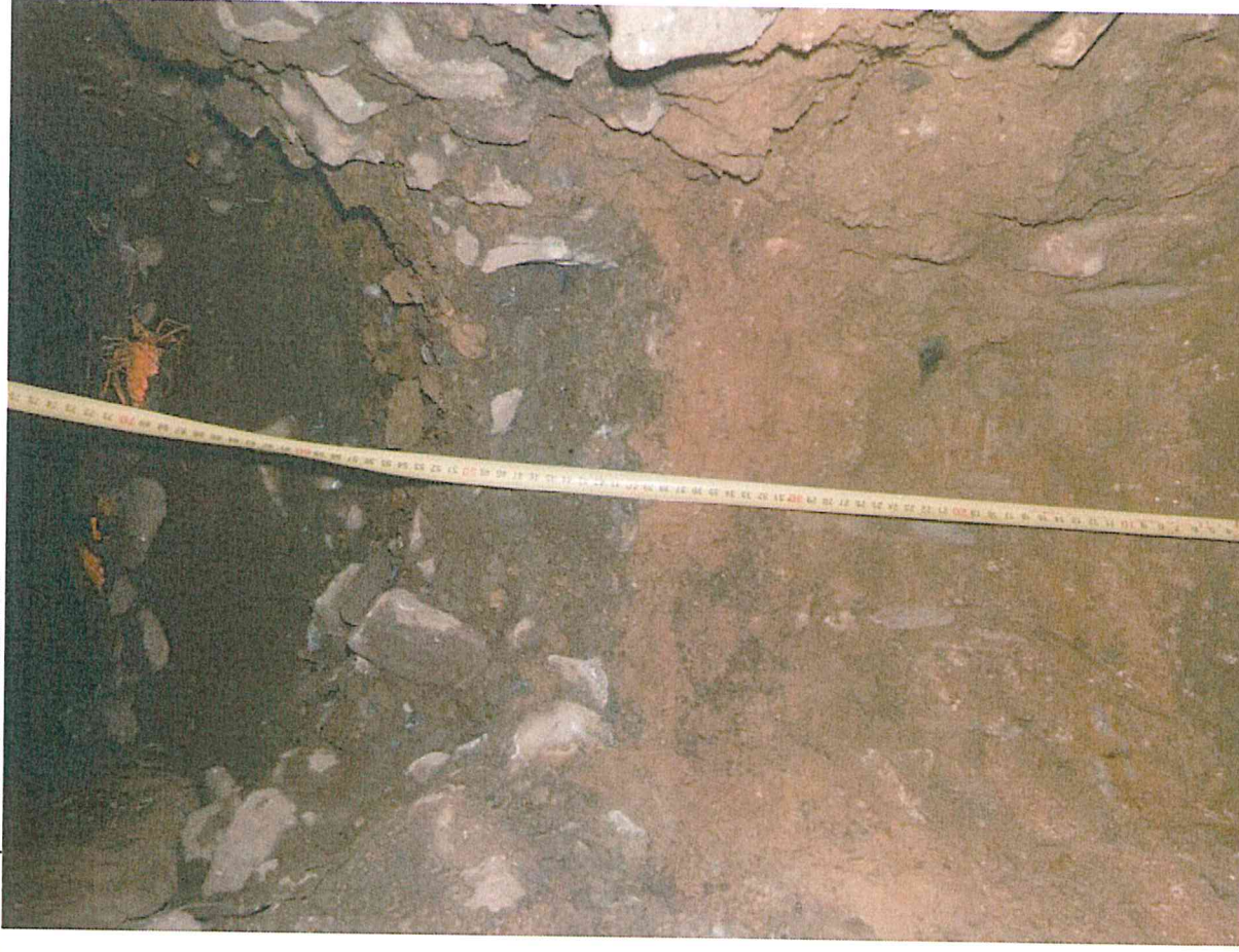
Foto č. 7 – Detail tloušťky konstrukčních vrstev sondy S1 Foto č. 8 – Detail sondy S1
