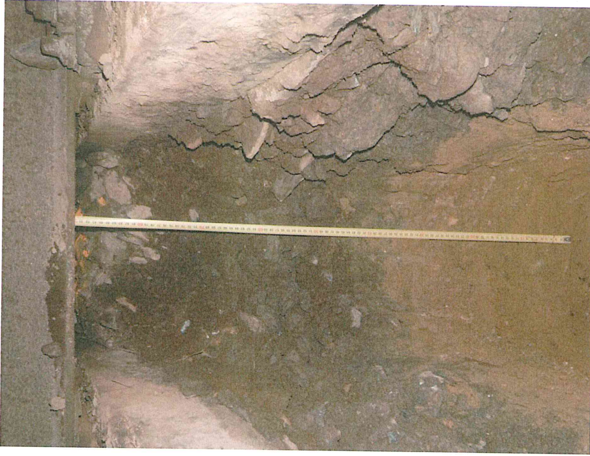
Foto č. 11 – Detail tloušťky konstrukčních vrstev sondy S2CONSULTTEST Foto č. 12 – Detail sondy S2
