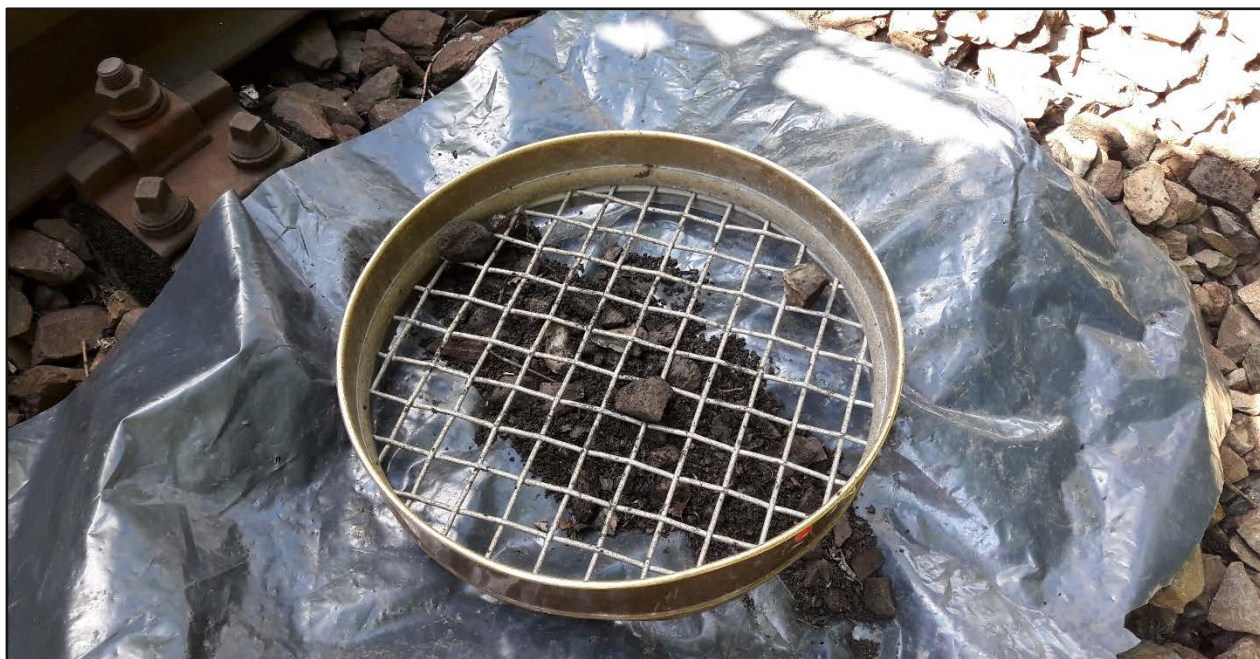
Obr. č. 1: Odebírání reprezentativního vzorku frakce < 32 mm
