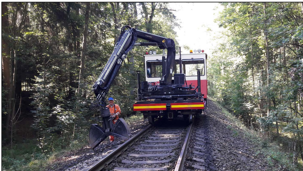
Obr. č. 2: Motorizovaná drezína při odbírání vzorků z kolejového lože
