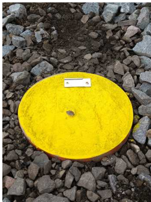
Obrázek 36 Schéma a ukázka základní odlehčené stabilizace
