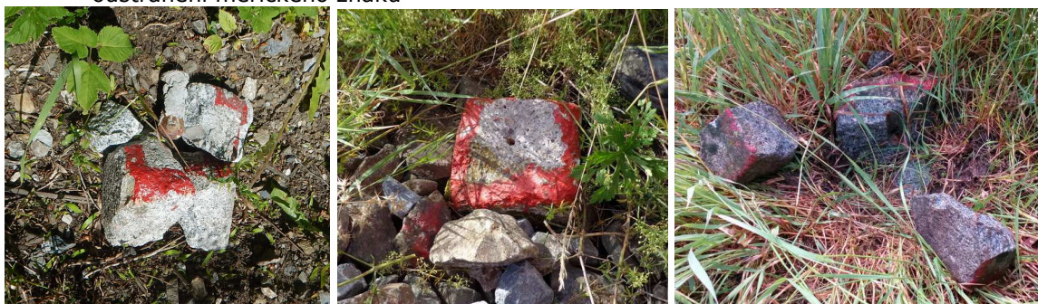
Obrázek 8 Ukázka zničených bodů sekáním trávy
