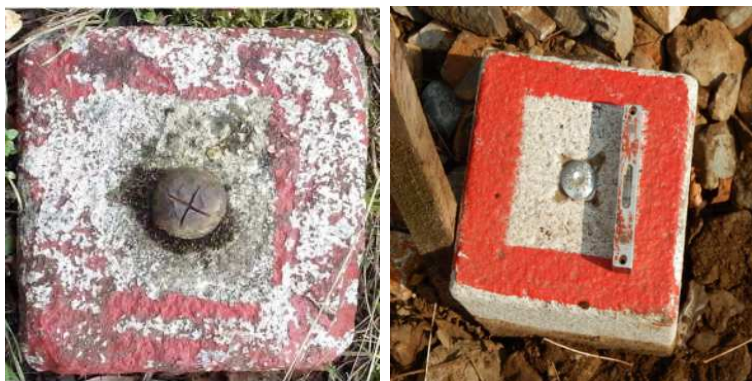
Obrázek 35 Hlava kamene se zabetonovaným nivelačním znakem a s měřickým hřebem (zleva)
