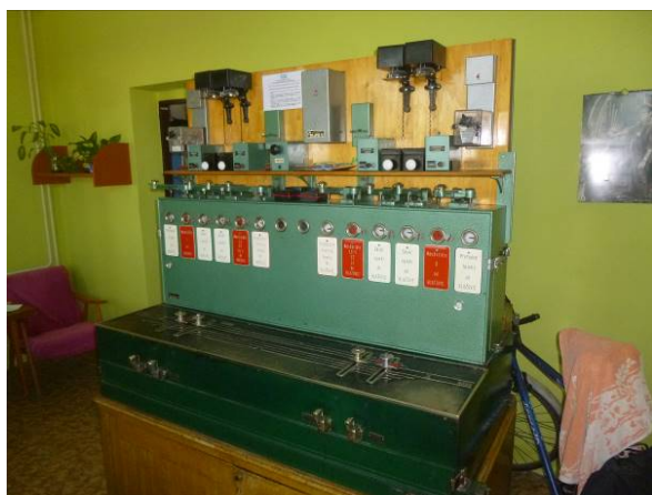
Obrázek 3: Řídící přístroj elektromechanického zabezpečovacího zařízení
