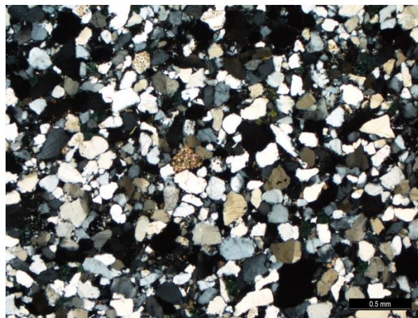
Obr. 6. Zaoblené až polozaoblené klasty křemene a ve střední části výbrusu ostrohranný úlomek karbonátu (XPL).
