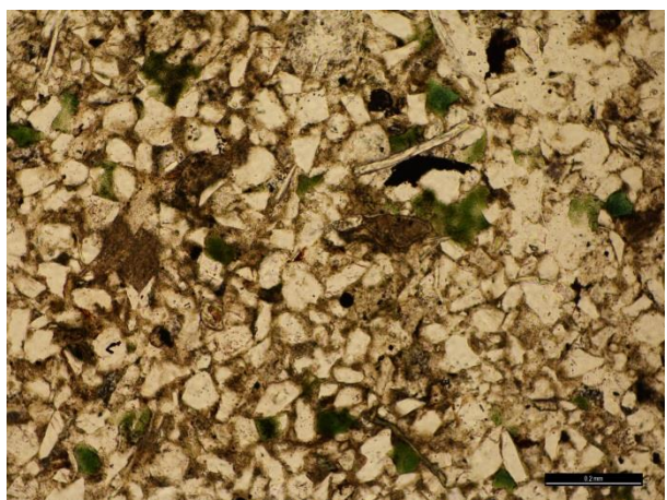
Obr. 3. Poloostrohranné klasty křemene, zelené agregáty zrn glaukonitu a lupínky slíd obklopené jílovito-karbonátovou základní hmotou (PPL).
