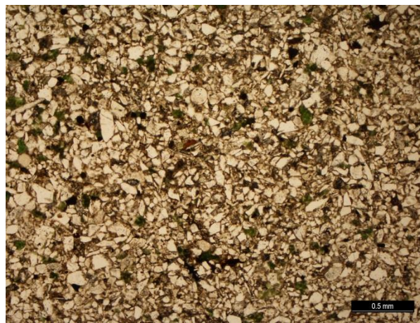
Obr. 2. Ostrohranné až poloostrohranné klasty dominantně tvořené křemenem, oválný průřez v horní části výbrusu reprezentuje průřez křemitou jehlicí huby (PPL).
