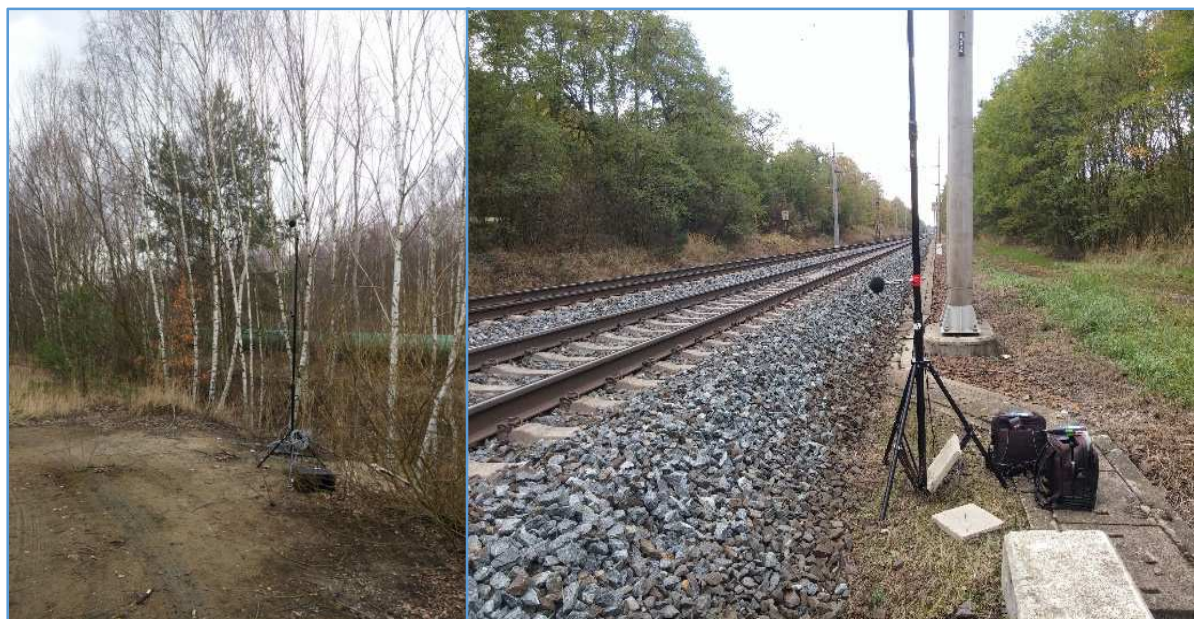
Obr. 6 - Poloha mikrofonů měřicího místa MM1 a MM0 v lokalitě III (V)
