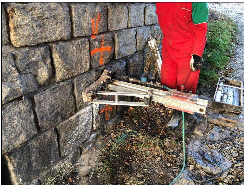
Obr. č. 14 - pohled na provádění vodní tlakové zkoušky ve vrtu V2
