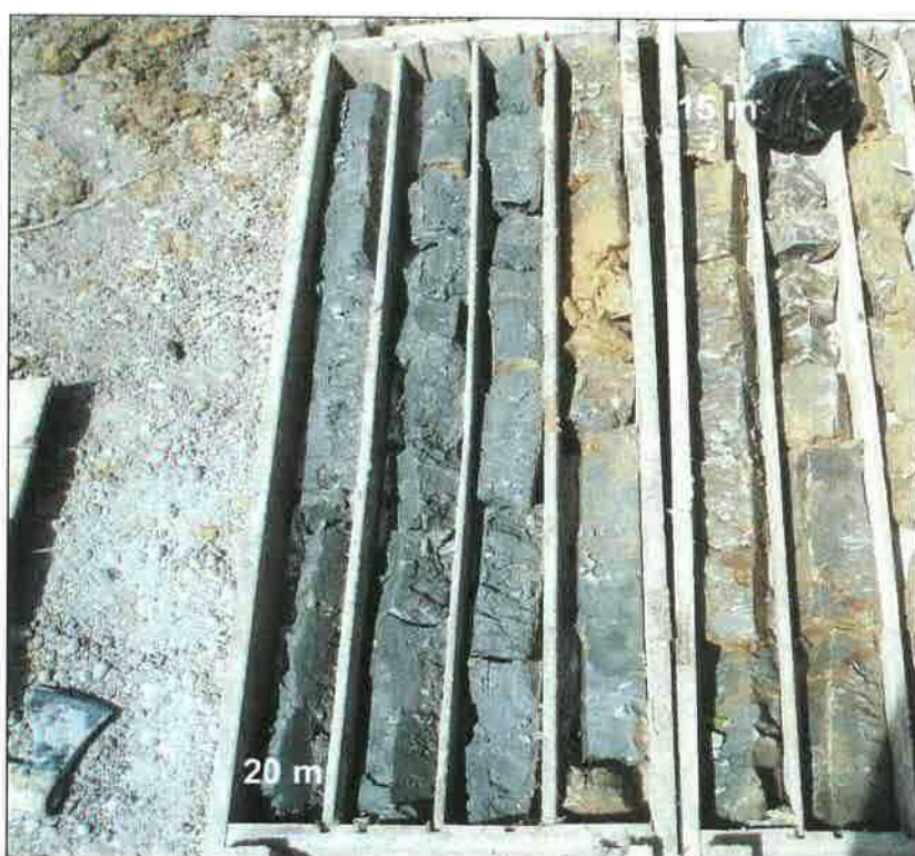
Foto č. 6 pohled na třetí část jádra inženýrsko-geologického vrtu M39.857P
