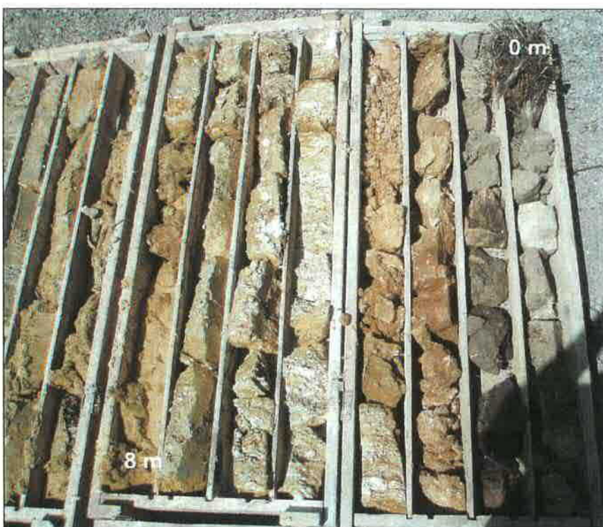
Foto č. 4 pohled na první část jádra inženýrsko-geologického vrtu M39.857P
