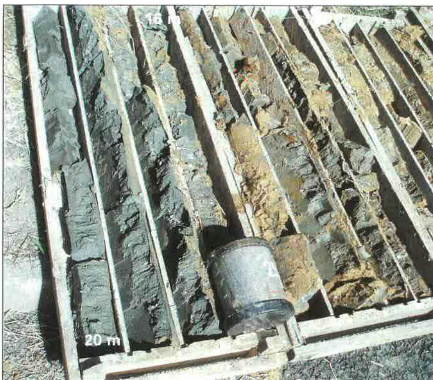
Foto č. 3 pohled na třetí část jádra inženýrsko-geologického vrtu M39.857L
