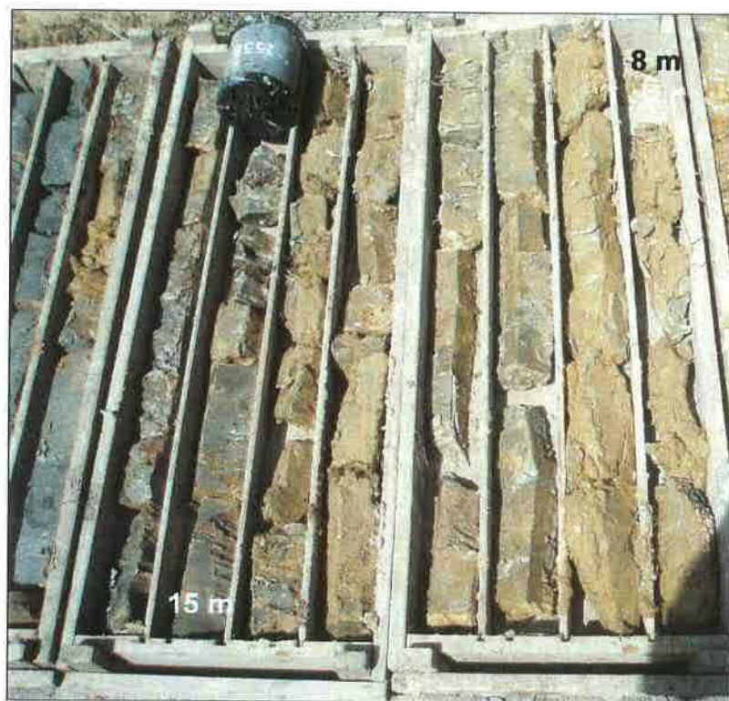
Foto č. 5 pohled na druhou část jádra inženýrsko-geologického vrtu M39.857P
