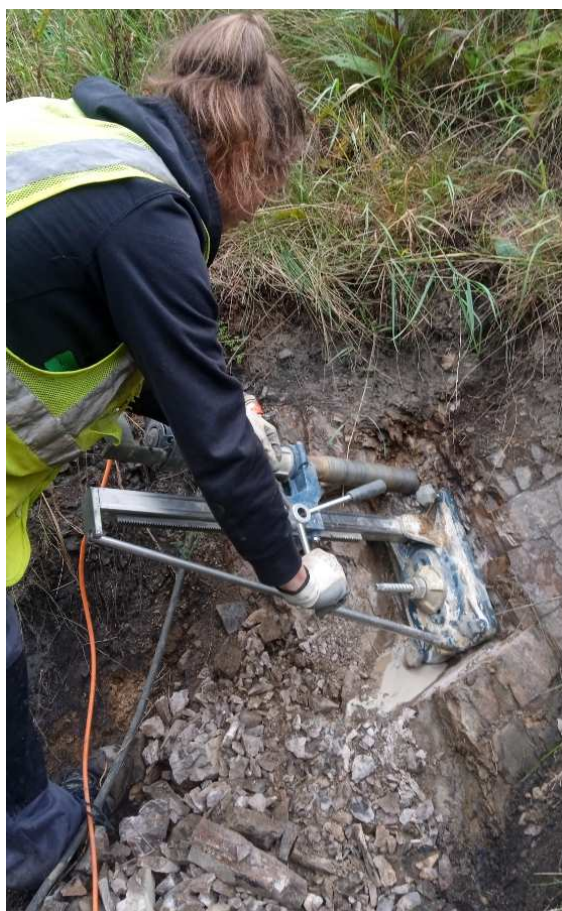
Obr. 4: Realizace jádrového vrtu za pomoci kotvené elektrické vrtačky s vodním výplachem
