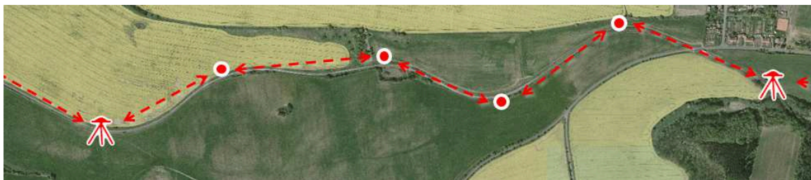
Obrázek 1 Polygonové body mezi dvěma body primární sítě
