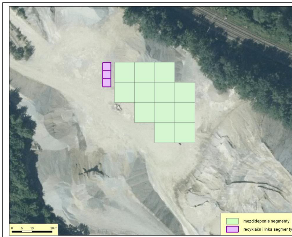
Obr. 3. Schematický zakres rozdělení a umístění plošných zdrojů znečištění v recyklační základně v kamenolomu Pohled
