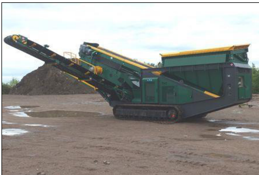
Obr. 2. Příklad použité recyklační linky: Jednotka Resta TH1 (zdroj: www.resta.cz )
