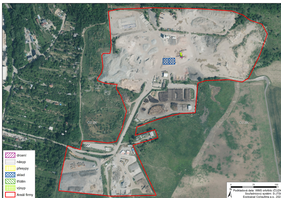
Obr. 3: Schematický zakres rozdělení a umístění plošných zdrojů znečištění v rámci recyklačního zařízení
