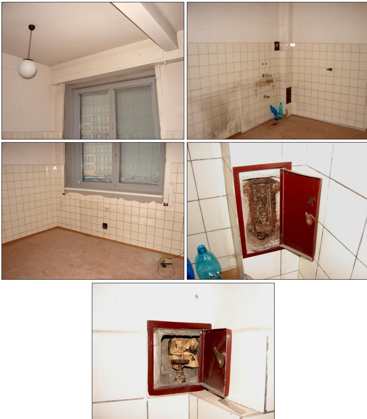
Foto 290 - 294: Místnost C.N2.18, ŽB skelet, výplňové zdivo, keramický obklad, na podlaze PVC, hliníková okna, za kovovými dvířky litinový svod a uzávěr vody
