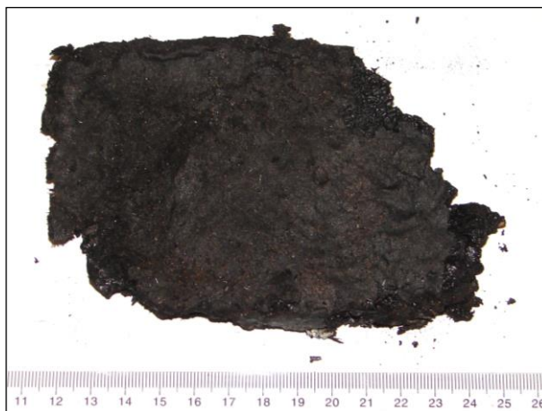
Foto 431: Střecha, severní křídlo, 2. vrstva: hydroizolační asfaltový pás původní (s tkaninou ze sklených vláken) přítomnost azbestu (plnivo): pozitivní, chryzotil identifikace (A), kap. 5.3
