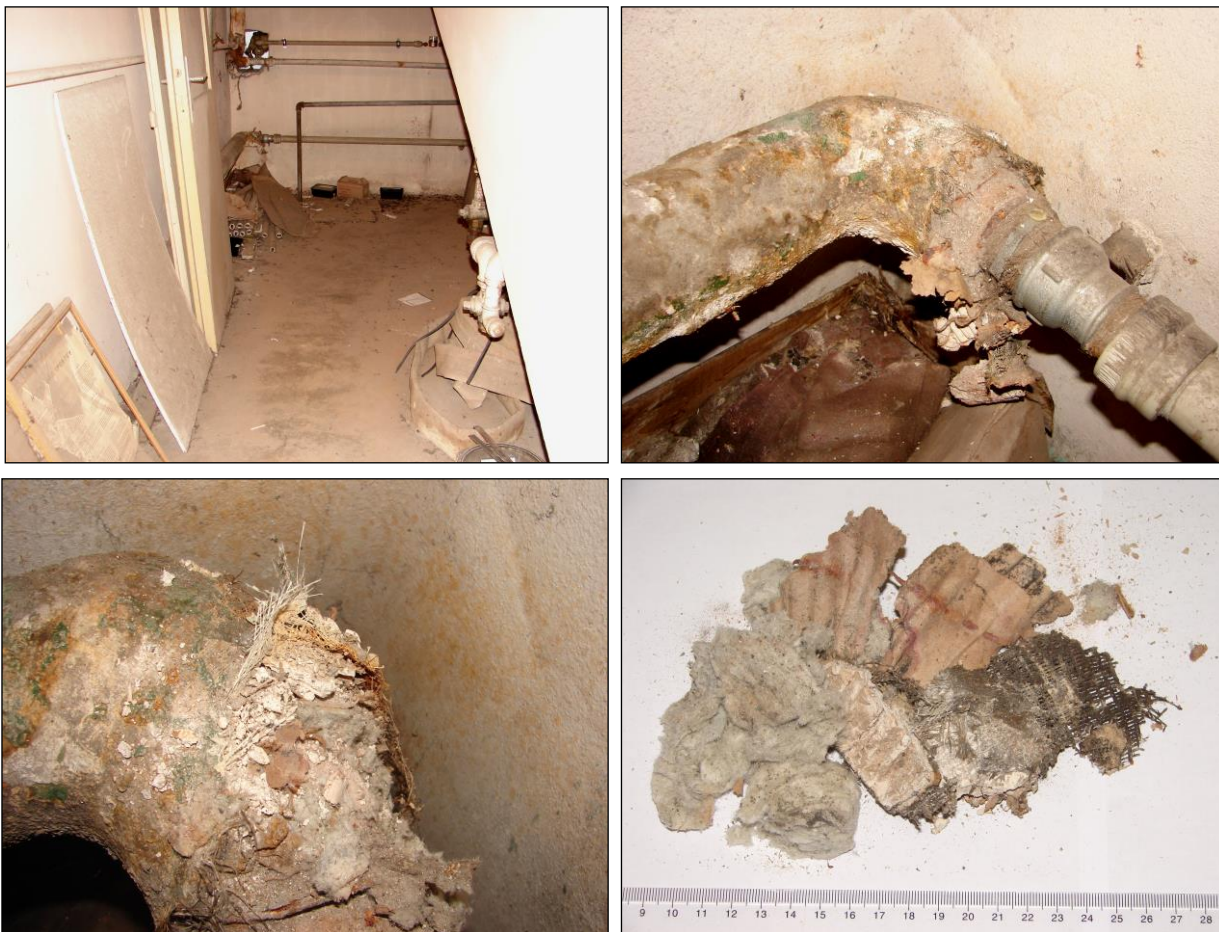
Foto 411 - 414: 1.NP, místnost C.N1.39, místo odběru vzorku (viz foto 59 - 64) a vzorek, ocelové potrubí s izolací z minerální vlny obalené kartonem a sádrou s textilní vložkou, přítomnost azbestu: negativní - identifikace (C), kap. 5.3
