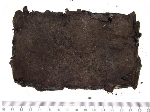
Foto 432 - 434: Střecha, severní křídlo, 3. - 5. vrstva: asfaltové lepenky s asfaltovými nátěry, přítomnost azbestu: negativní - identifikace (B), (C), kap. 5.3
