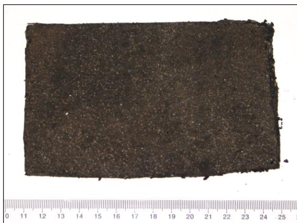
Foto 430: Střecha, severní křídlo, 1. vrstva: hydroizolační asfaltový pás novodobý (pískovaný) přítomnost azbestu (plnivo): negativní identifikace (A), kap. 5.3
