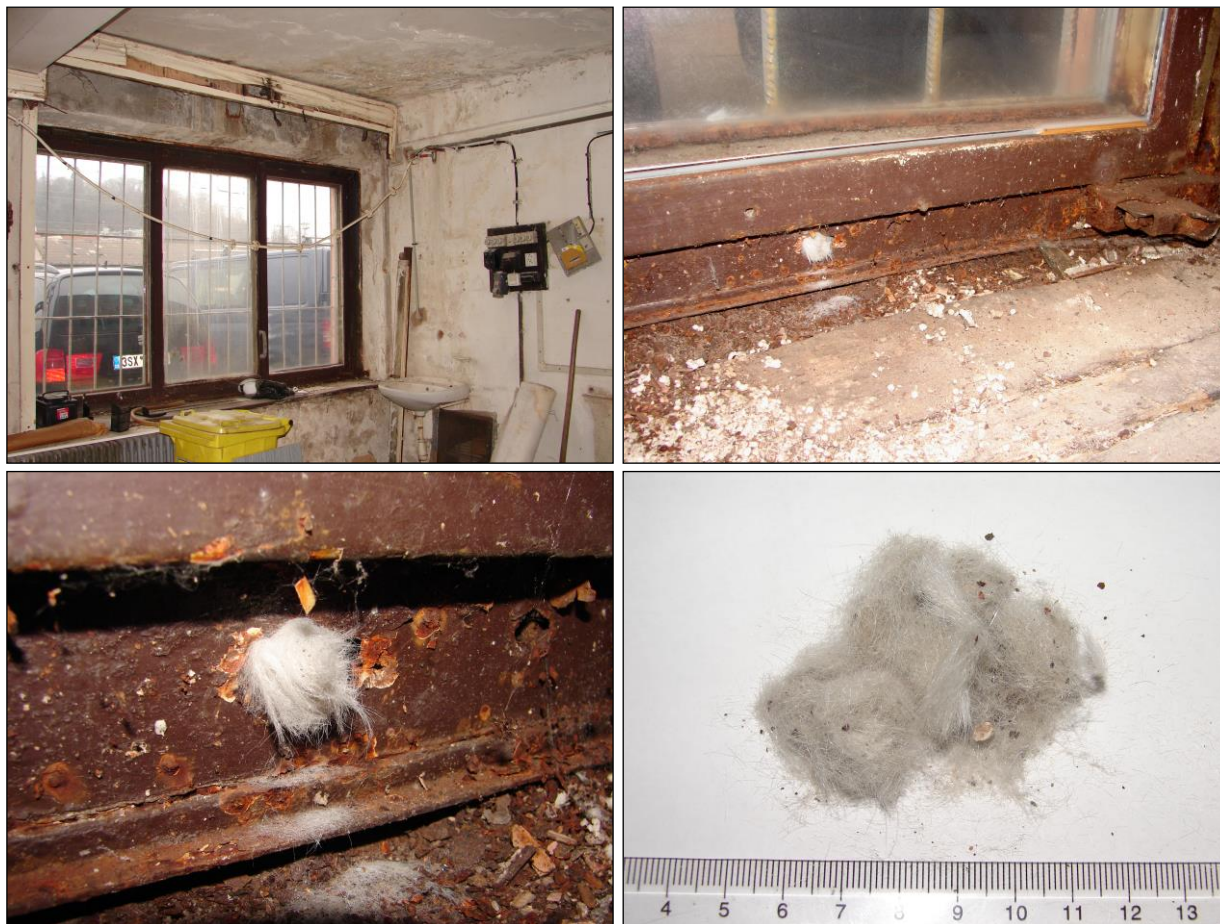
Foto 415 - 418: 2.NP, místnost C.N2.31, místo odběru vzorku (viz foto 247 - 252) a vzorek, v kovovém rámu okna tepelná izolace ze skelných vláken přítomnost azbestu: negativní - identifikace (C), kap. 5.3
