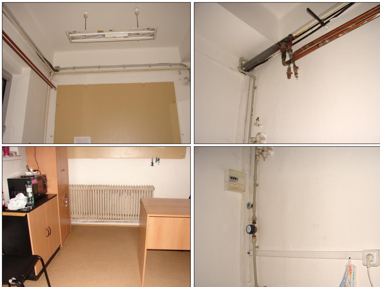
Foto 219 - 222: Místnost B.N1.30, ŽB skelet, výplňové zdivo, PVC na podlaze, ocelové a plastové potrubí, hliníkové okno, el. rozvody v plastové skříni
