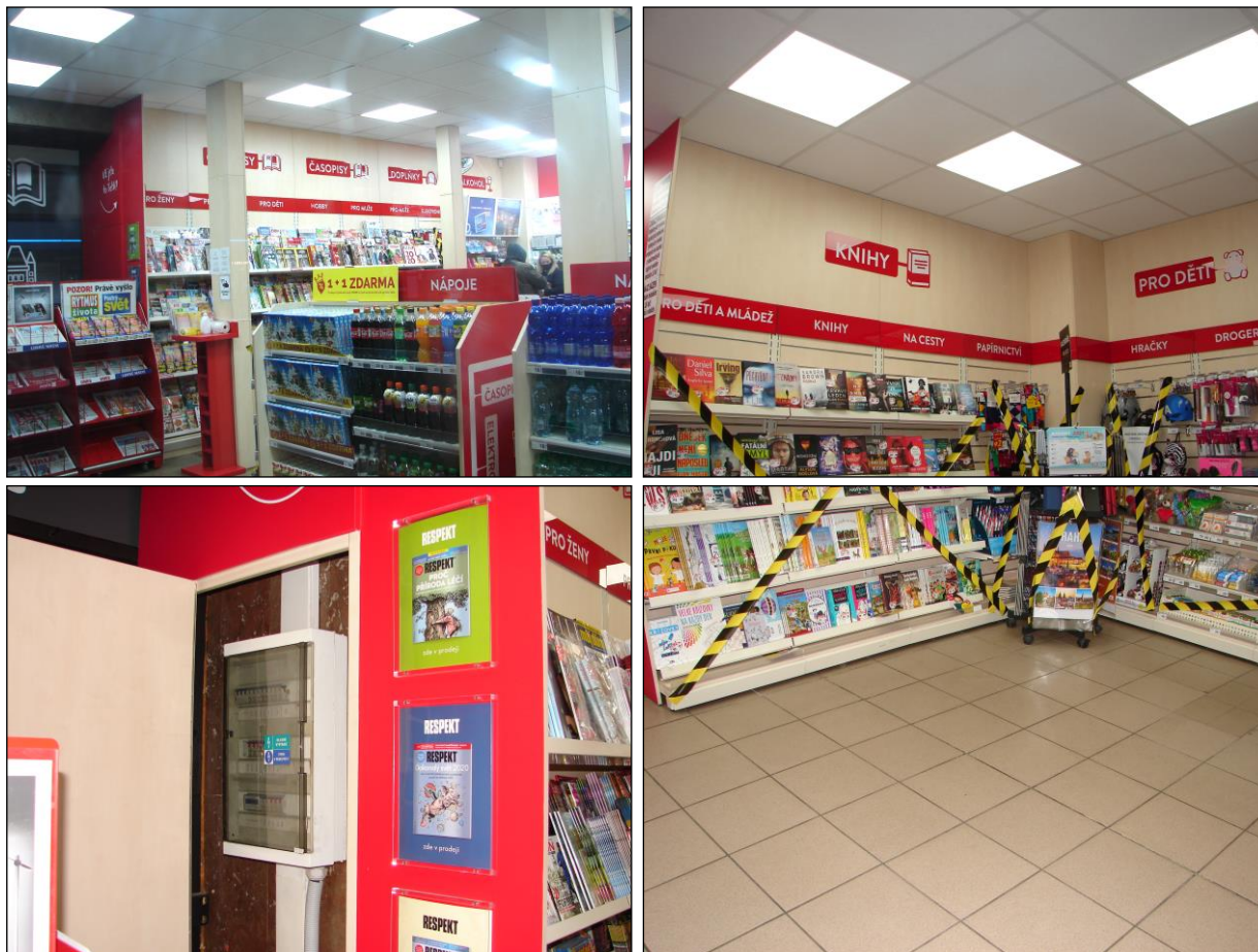
Foto 234 - 237: Místnost B.N1.35, prodejna trafiky, ocelové sloupky obložené dřevotřískovými deskami, zavěšený kazetový podhled, keramická dlažba na podlaze, el. rozvody v plastové skříně
