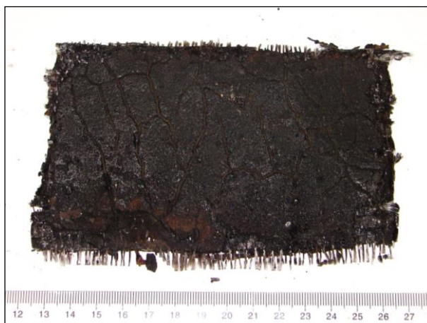
Foto 431: Střecha, severní křídlo, 2. vrstva: hydroizolační asfaltový pás původní (s tkaninou ze sklených vláken) přítomnost azbestu (plnivo): pozitivní, chryzotil identifikace (A), kap. 5.3
