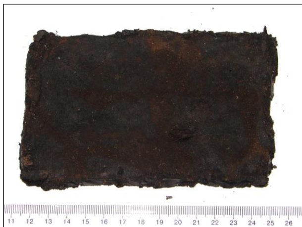
Foto 430: Střecha, severní křídlo, 1. vrstva: hydroizolační asfaltový pás novodobý (pískovaný) přítomnost azbestu (plnivo): negativní identifikace (A), kap. 5.3
