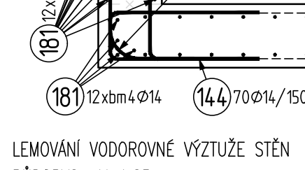
LEMOVÁNÍ L16 – 3bm; 2ks PŘÍČNÝ REZ M 1:25
