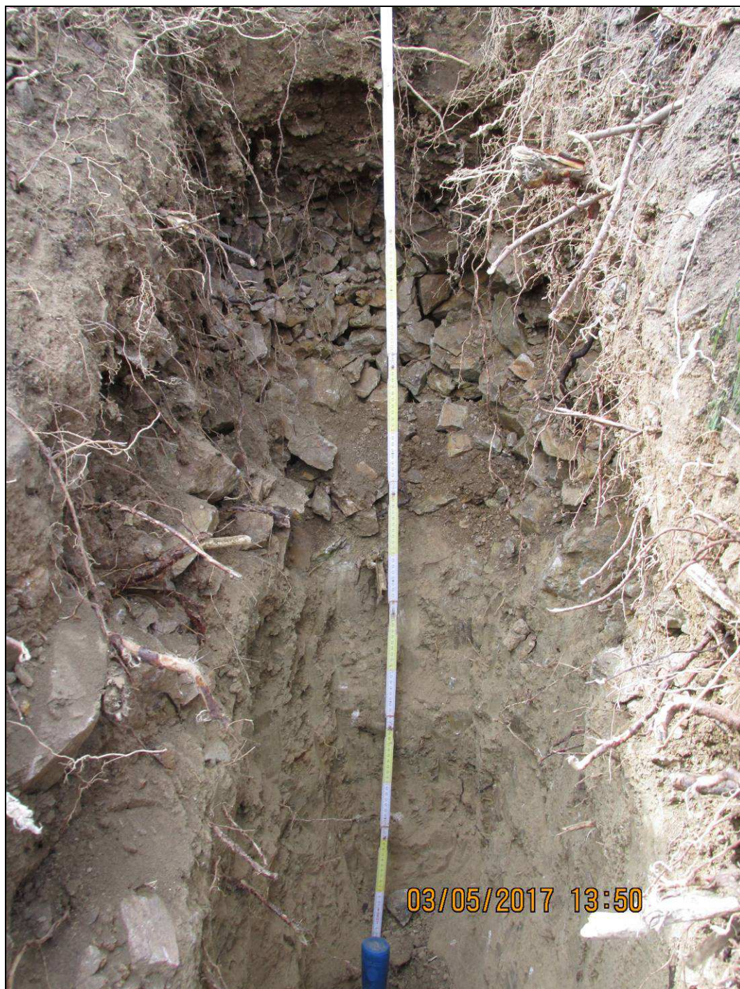
Obr. č. 8 - profil kopané sondy ve svahu za korunou zdi
