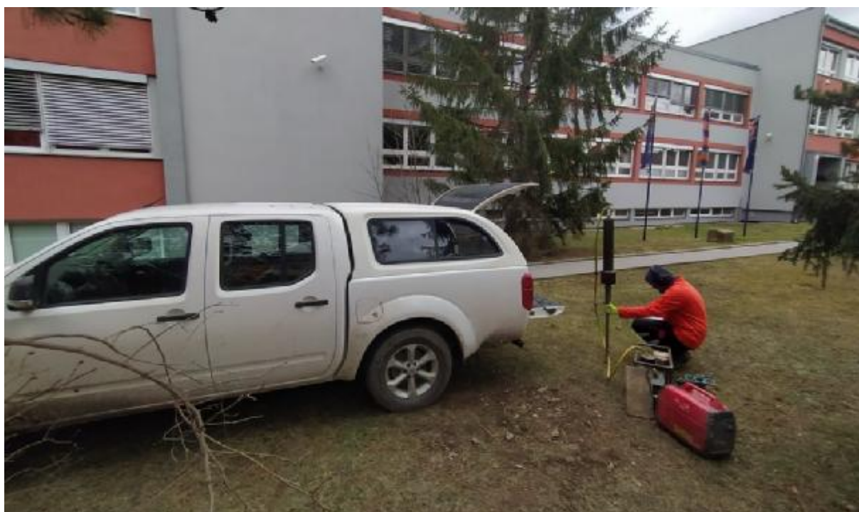
Obr. 4 Realizace sondy střední dynamické penetrace DP 1
