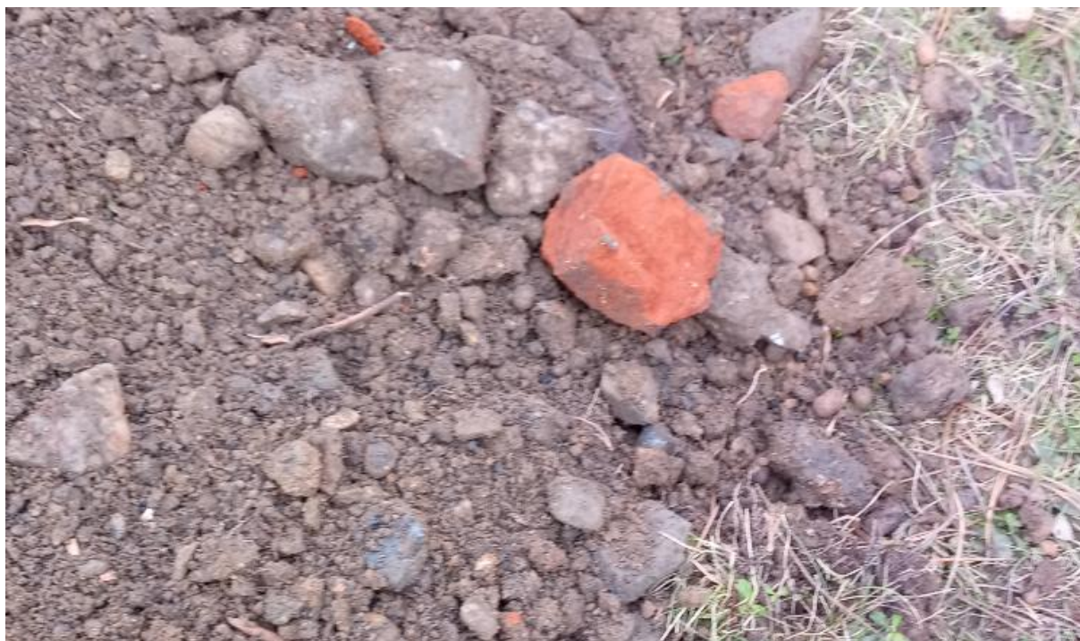
Obr. 3 Charakter navážek v místě realizace kopané sondy KS 1
