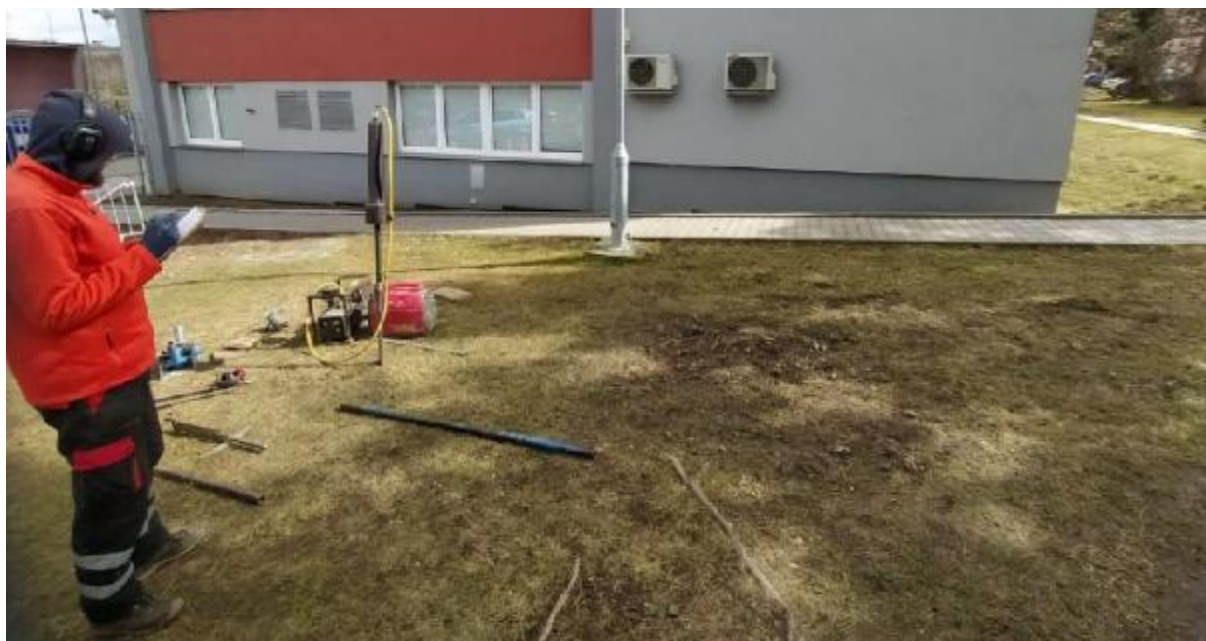
Obr. 6 Realizace sondy střední dynamické penetrace DP 2
