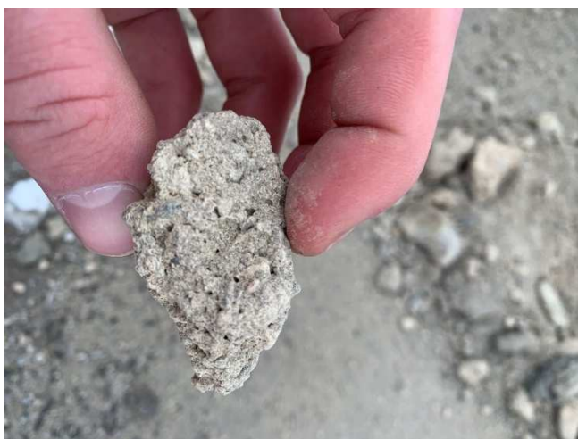
obr. 11 Vzorek pórovité betonové mazaniny
